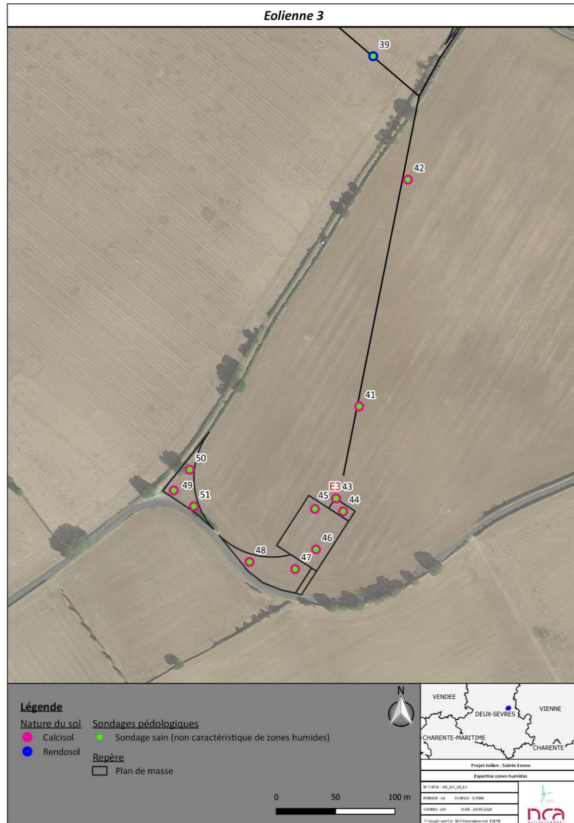
Figure 175 : Localisation des sondages pédologiques sur le plan de masse de l'éolienne 3 (Sources : NCA Environnement, ©IGN Scan 25 et ©IGN BD Ortho)
