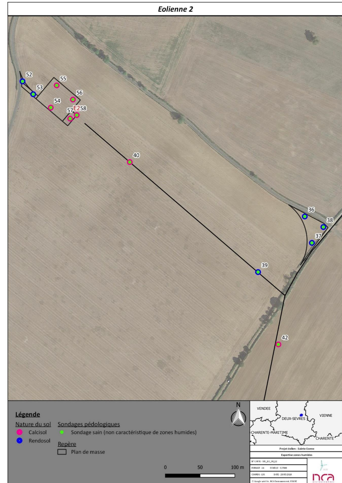
Figure 174 : Localisation des sondages pédologiques sur le plan de masse de l'éolienne 2 (Sources : NCA Environnement, ©IGN Scan 25 et ©IGN BD Ortho)
